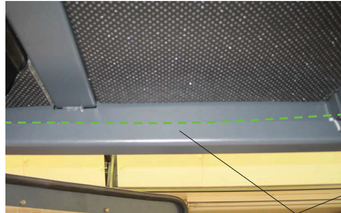
Kabelbaumführung W13 sowie W14 geführt im Kabinendach, rechtes
